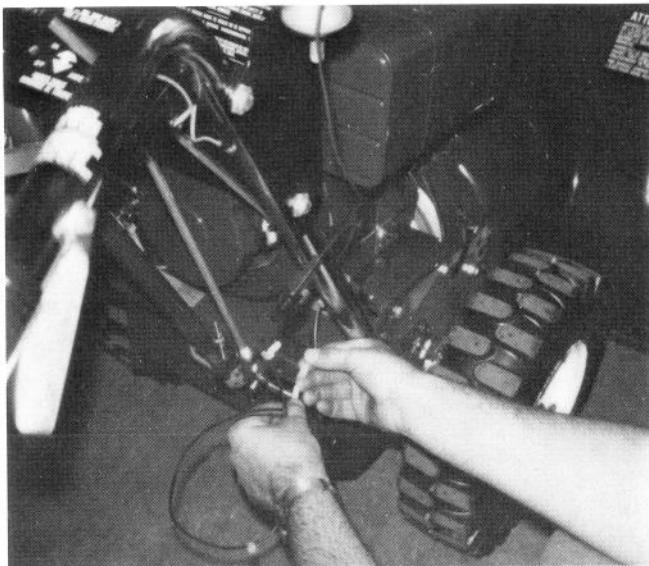
En utilisant des dispositifs de retenue pour les fils, fixez le fil au mancheron.
