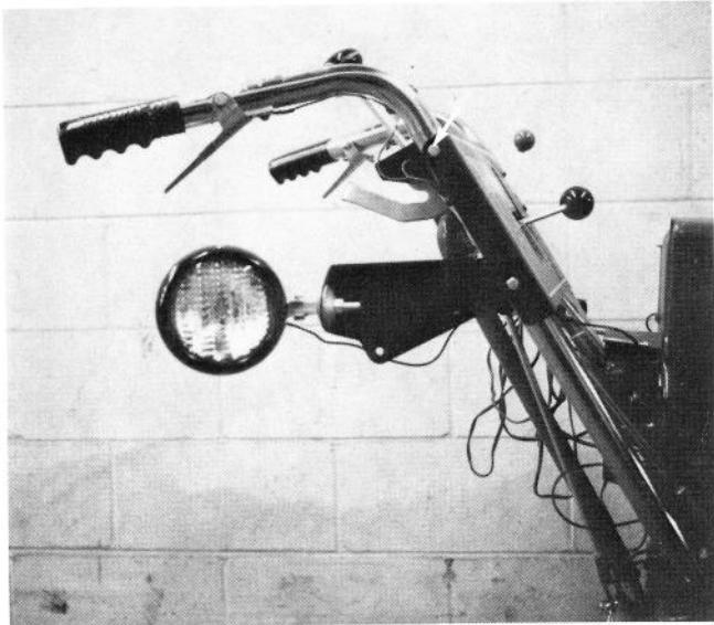
Faites pivoter le support et l'assemblage du phare vers le haut et revissez au tableau et au mancheron à l'aide des attaches enlevées à l'étape précédente.
