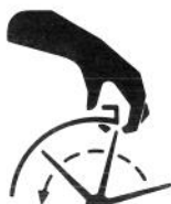
Arrêter le moteur avant de déboucher le dispositif de décharge
