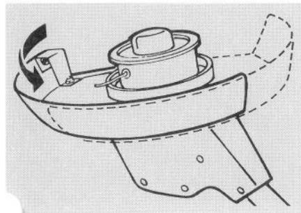
2. Das Schutzschild eine viertel Umdrehung fest nach rechts drehen, so daB die Nase am Ansatz hinten am Motorgehäuse anliegt.
