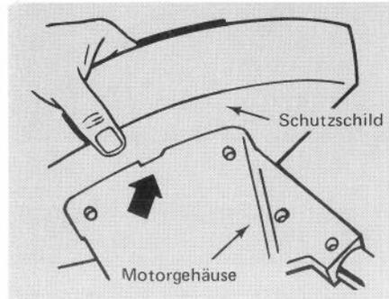
1. Das Schutzschild so auf das Motorgehäuse setzen, daB die Nase (Pfeil) mittig zur rechten Hälfte des Motorgehäuses steht.
