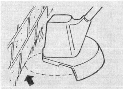
4. Möglichst immer nach links schneiden, denn dann wird die Schneidleistung noch besser, weil der Schneidfaden das Gras berührt, sobald er aus dem Leit- und Schutzschild austritt und das Schnittgut vom Bediener weg ausgeworfen wird.
