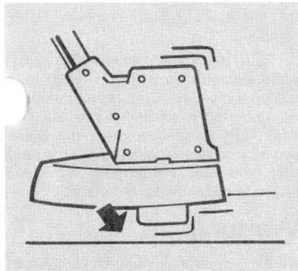
1. Zum Abspulen des Schneidfadens die Spule bei laufendem Motor kurz auf den Boden tippen. Der Faden spult sich dann ab und wird von der Klinge am Leitblech auf die richtige Länge zugeschnitten.
