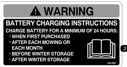
1. Attention – lisez le *Manuel de l'utilisateur* pour connaître la procédure correcte de charge de la batterie. La batterie contient du plomb, ne la mettez pas au rebut.
