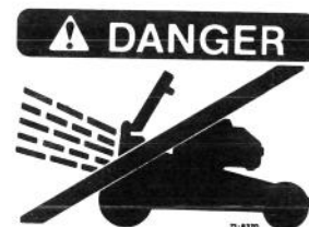
Öffnen Sie die Auswurfür des Mähers nie bei laufendem Motor, wenn der Grassack nicht montiert ist.
