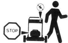
Vor Verlassen der Bedienerposition den Motor abstellen
