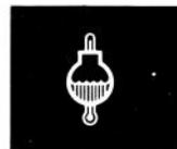
TEMPERATURA DEL REFRIGERANTE DEL MOTOR
