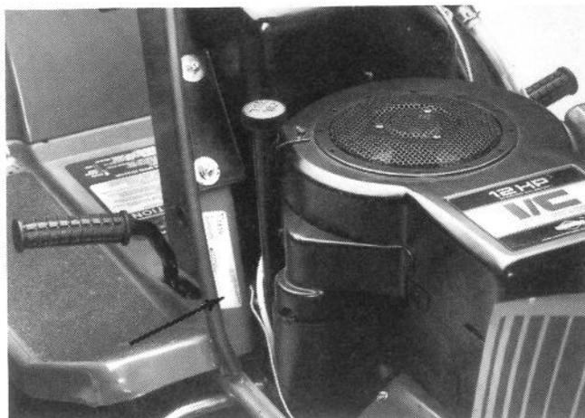
Collocazione numeri del motore e di matricola
