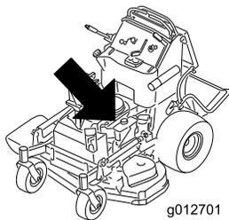
Hueco entre electrodos: 0,76 mm
