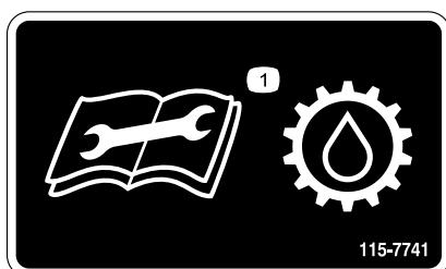
1. Прочтите Руководство водителя-оператора перед обслуживанием трансмиссионной жидкости.
