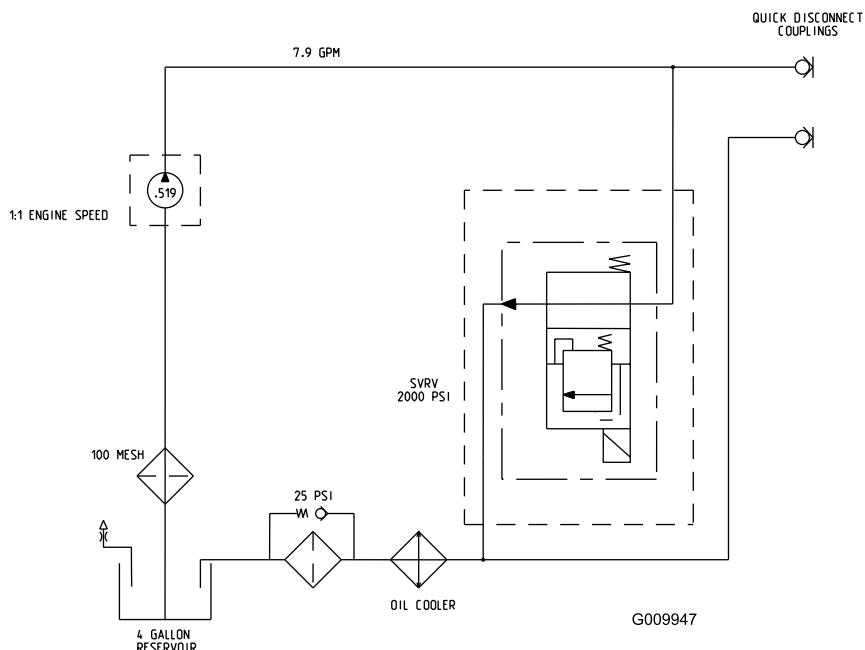
Гидравлическая схема системы с большим расходом (только на моделях ТС) (Rev. A)
