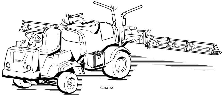
El pulverizador para césped Multi-Pro® es un vehículo dedicado a la aplicación de productos al césped por pulverización, y está diseñado para ser usado por operadores profesionales contratados en aplicaciones comerciales. Está diseñado principalmente para pulverizar césped bien mantenido en parques, campos de golf, campos deportivos y zonas verdes comerciales.
