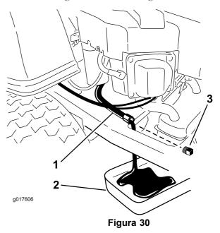
Tubo de vaciado de aceite 3. Tapón de vaciado del aceite
