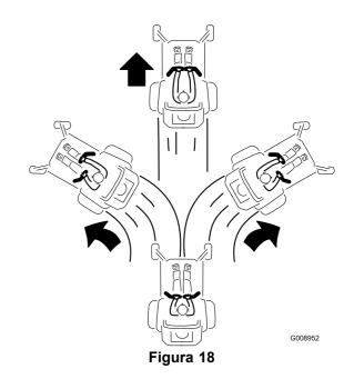
Para ir recto, aplique la misma presión a ambas palancas de control de movimiento (Figura 16).
