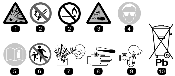
バッテリーに関する注意標識 全てがついていない場合もあります
