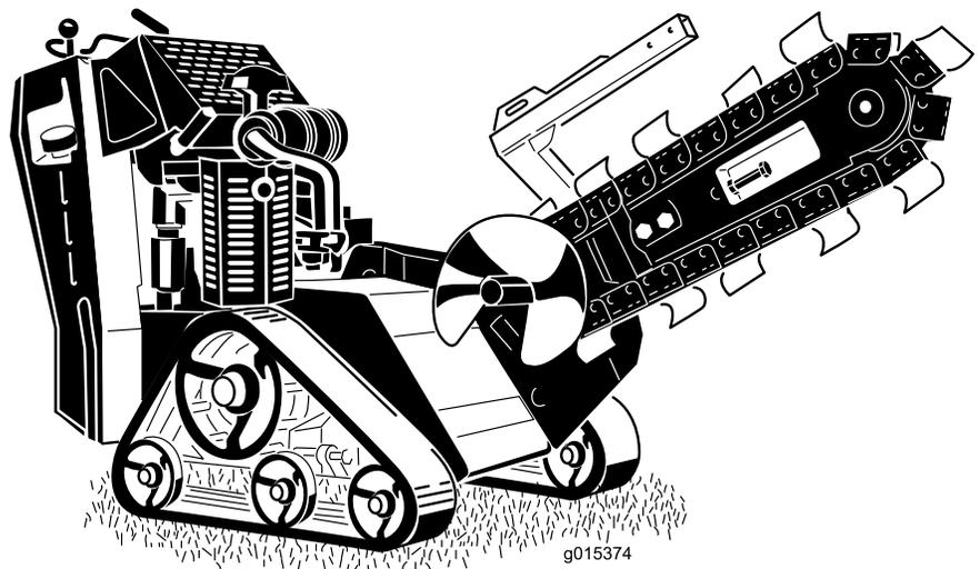
Cette machine est conçue pour creuser des tranchées dans la terre pour la pose de canalisations et de câbles destinés à diverses applications. Elle n'est pas prévue pour creuser dans la roche, le bois ou toute matière autre que la terre.
