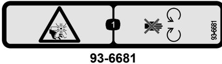
1. Peligro de corte/desmembramiento, ventilador – no se acerque a las piezas en movimiento.
