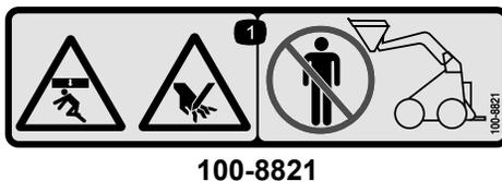
1. Peligro de aplastamiento y corte de la mano – manténgase a una distancia prudencial de la parte delantera de la unidad de tracción cuando los brazos de carga están elevados.
