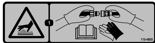
1. Peligro – superficie caliente – Lleve guantes de protección al manejar los acoplamientos hidráulicos y lea el *Manual del operador* para informarse de cómo manejar los componentes hidráulicos.
