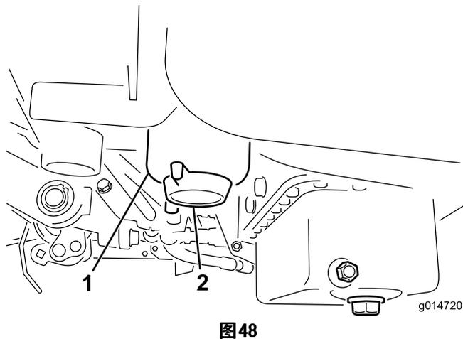
1. 燃油滤清器/水分离器过 2. 滤清器排油塞
