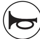
**Wichtig: Vermeiden von Schäden: Die Hupe ertönt automatisch, wenn das Motorkühlmittel oder das Hydrauliköl überhitzt. Stellen Sie den Motor SOFORT ab und beheben Sie das Problem, bevor Sie den Motor erneut anlassen.**
