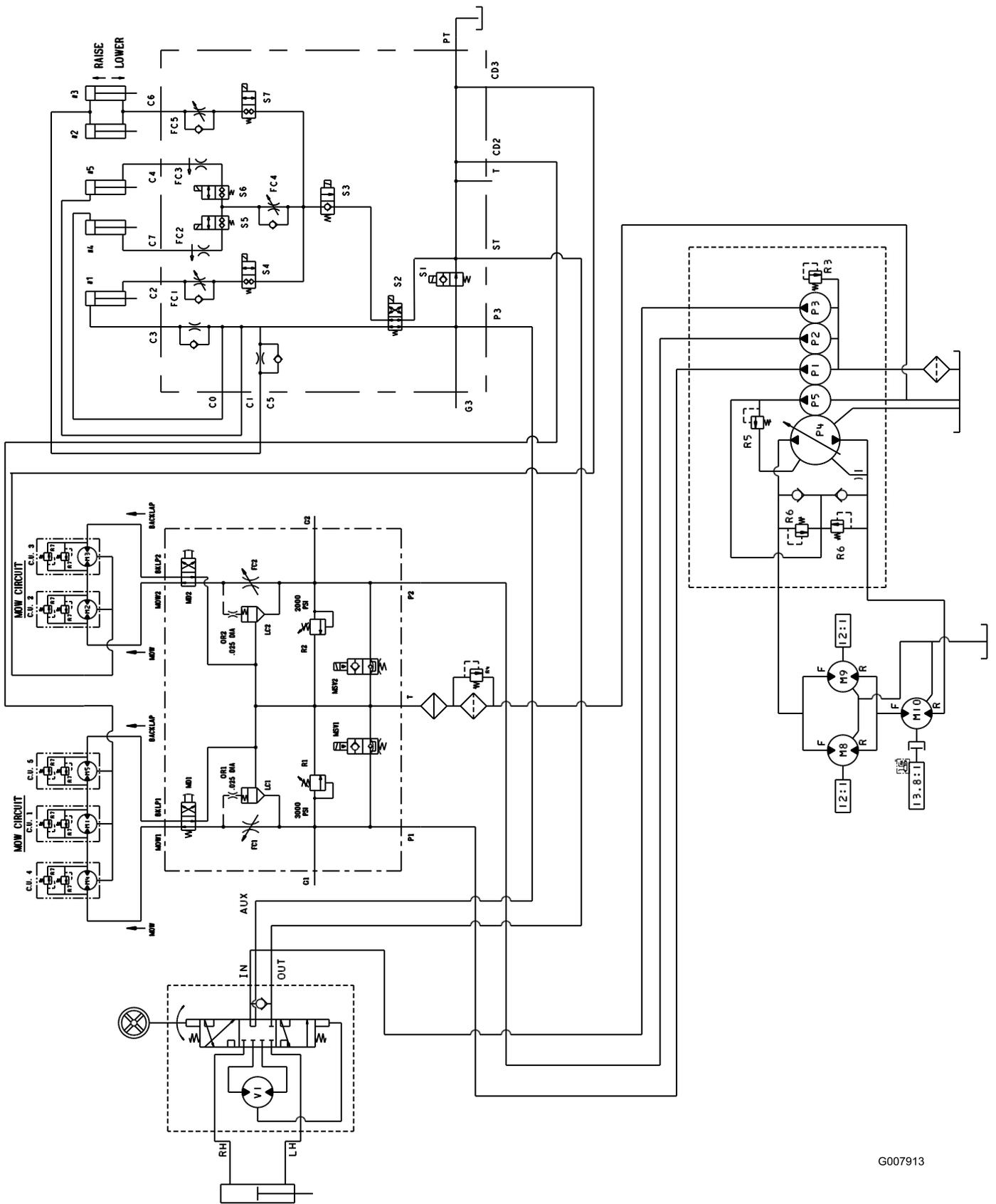
Schéma hydraulique, Modèle 03807 et 03812 (Rev. -)
