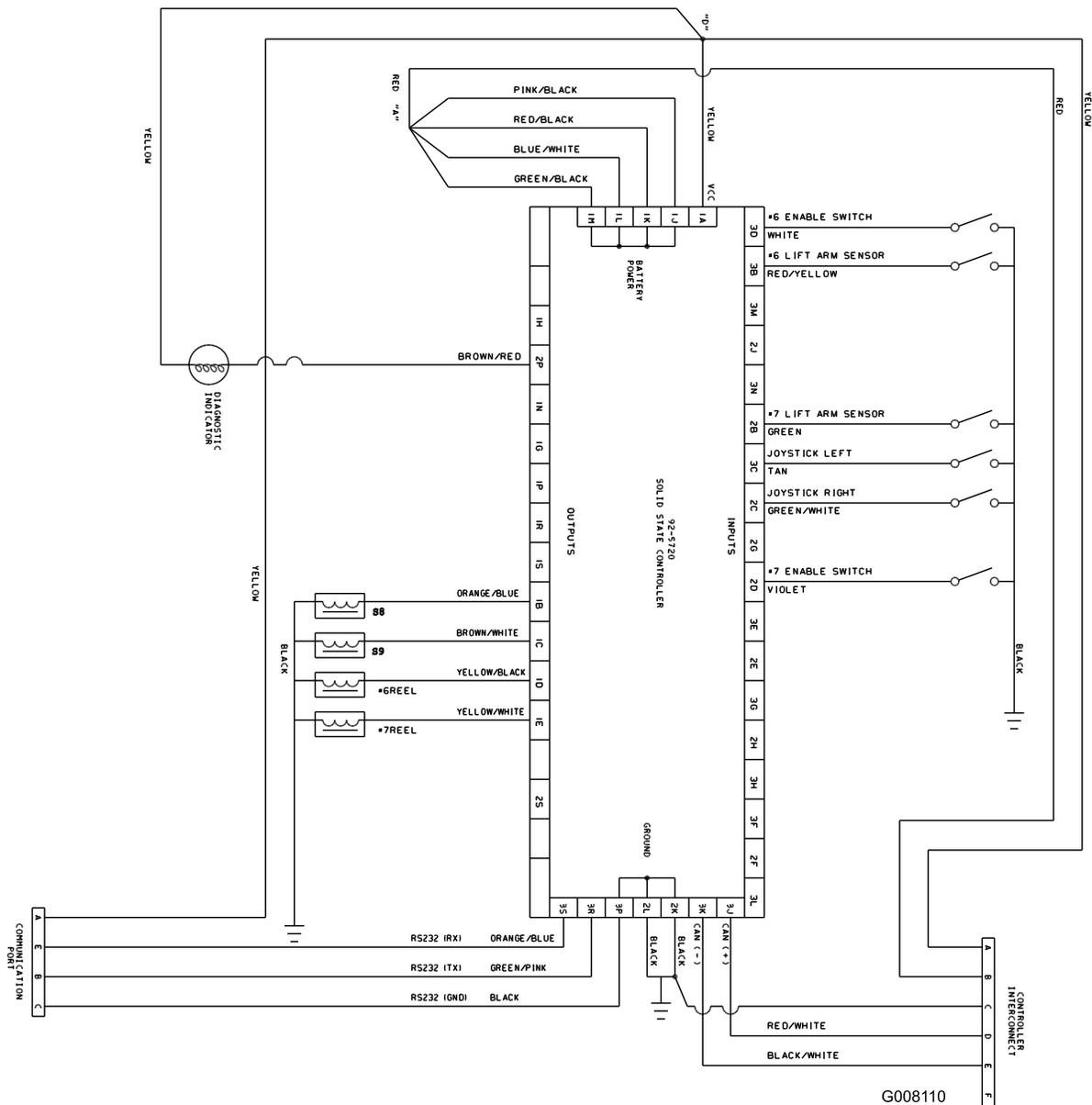
Schéma électrique, modèles 03808 et 03813 uniquement (Rev. A)
