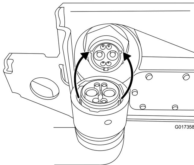
10. 顺时针旋转线束插头上的锁紧环，直至与电池插座接合，然后开始向内拉动电池。继续再旋转 120 度 (1/3 圈)，直至它完全到位。
