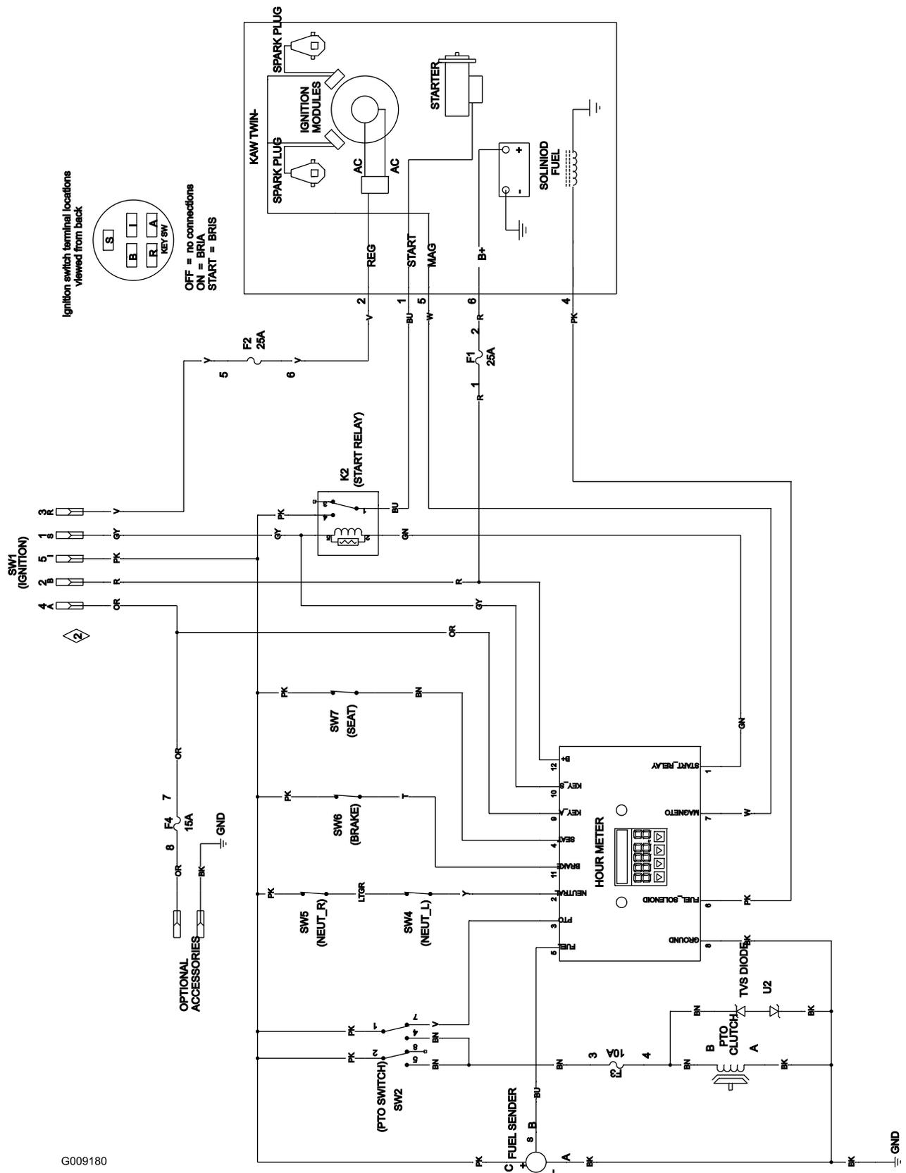
Schéma de câblage (Rev. A)
