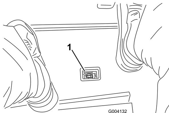
1. Indicateur de colmatage du filtre hydraulique
