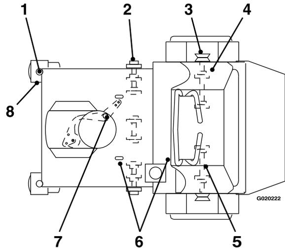
\*Voir l'opération 3 pour les instructions de graissage spéciales des pivots des roues pivotantes avant.
