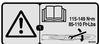
1. 警告ブレードボルト/ナットは115149 Nm 11.815.2 kg.mにトルク締めするトルク締めの方法についてはオペレーターズマニュアルを読むこと。
