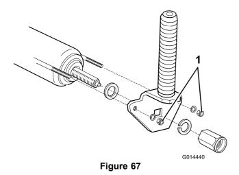
1. Écrous de maintien du câble de racloir
