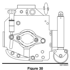
Tête de coupe flottante MK3 de 20 cm : Lorsque la tondeuse est équipée de têtes de coupe flottantes, la hauteur de coupe est jaugée d'après les rouleaux avant et arrière. La tête de coupe peut pivoter latéralement en avant et arrière. Cet agencement est celui préconisé pour les pelouse de haute qualité et donne de bons résultats sur l'herbe basse et les terrains très ondulés (Figure 31).
