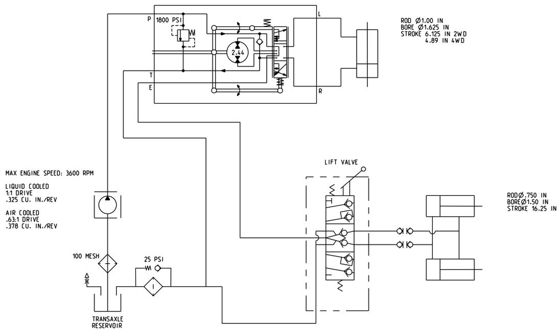
Гидравлическая схема (Rev. B)
