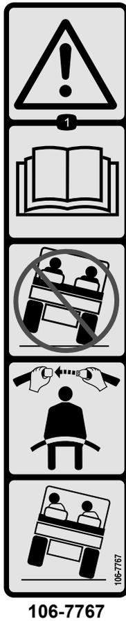
1. Attention – lisez le *Manuel de l'utilisateur* ; évitez de renverser la machine, attachez la ceinture de sécurité, penchez-vous dans la direction opposée si la machine se renverse.
