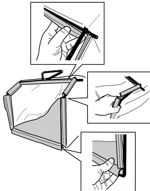
3. Enganche los canales superiores y laterales de la bolsa en la parte superior y en los laterales del bastidor, respectivamente ([Figura 7](#)).
