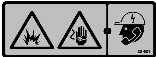
1. Опасность взрыва, опасность поражения электрическим током – до начала выемки грунта в обязательном порядке свяжитесь с местными коммунальными службами.
