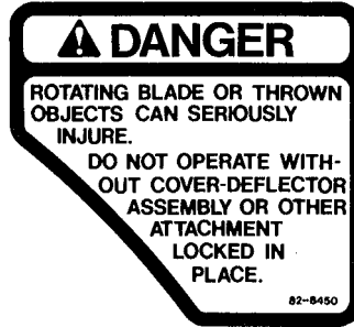
DEBAJO DEL MONTAJE TAPA-DEFLECTOR EN LA CUBIERTA DE LA CORTADORA (Nº de ref. 82-8450)
