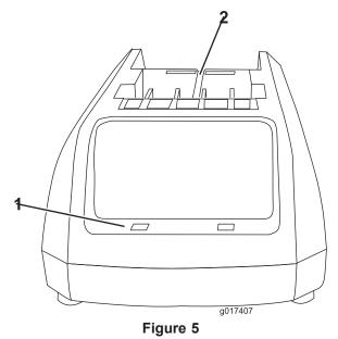
1. Diodes 2. Insérez la batterie ici
