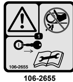
1. Advertencia - No toque ni se acerque a las correas en movimiento; retire la llave de contacto y lea las instrucciones antes de realizar cualquier operación de mantenimiento o ajuste a la máquina.
