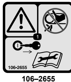
1. Advertencia - No toque ni se acerque a las correas en movimiento; retire la llave de contacto y lea las instrucciones antes de realizar cualquier operación de mantenimiento o ajuste a la máquina.
