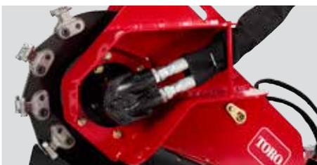
**HYDRAULIK ANGETRIEBENEN KOPF**
